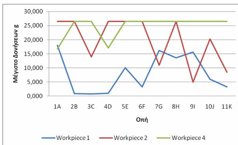
Σχήμα 4.19: Μέγιστες τιμές δονήσεων σετ διαγωνίου, για κάθε κομμάτι κατεργασίας
