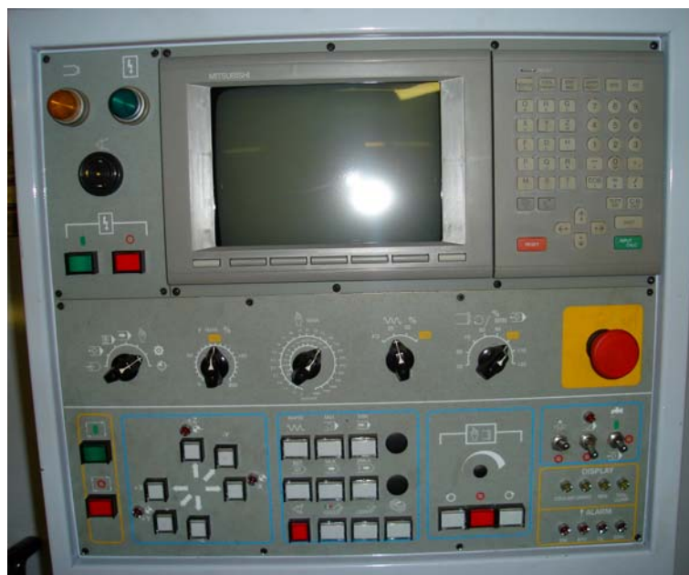
Σχήμα 2.2: Ελεγκτής κάθετου κέντρου κατεργασίας
