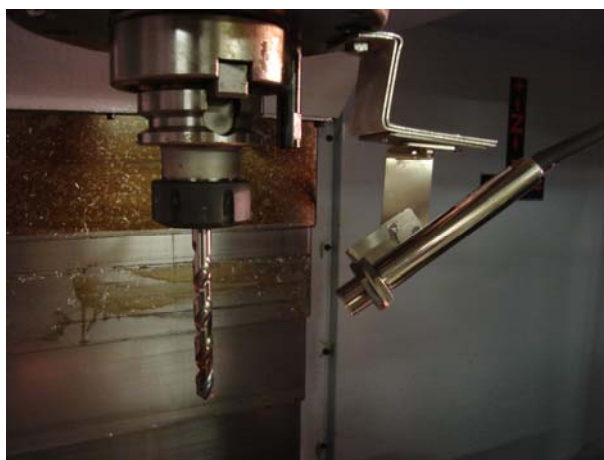
Σχήμα 2.14: Εγκατάσταση θερμομέτρου Rayomatic 10
