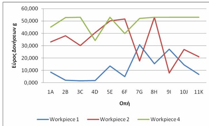
Σχήμα 4.21: Εύρος δονήσεων του σετ διαγωνίου στα κομμάτια κατεργασίας
