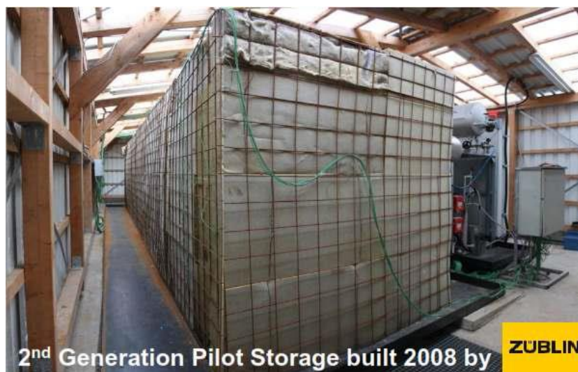
Εικόνα 3.5: Πειραματική διάταξη από σκυρόδεμα με δυνατότητα αποθήκευσης 400 kWh θερμικής ενέργειας. [10]
