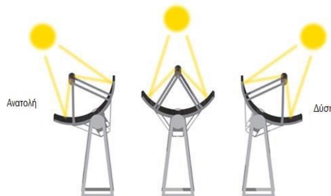
Σχήμα 3.9: Παρακολούθηση της θέσης του ήλιου (άξονας εγκατάστασης B-N) [3]
