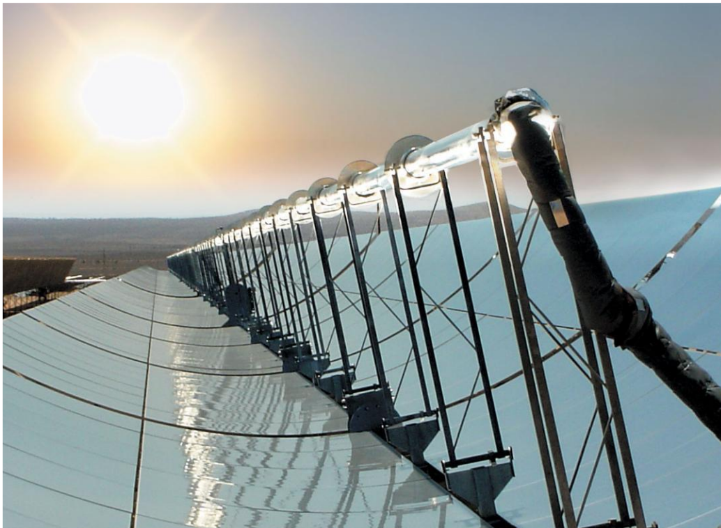
Εικόνα 2.1: Αποψη παραβολικού συλλέκτη [13]
