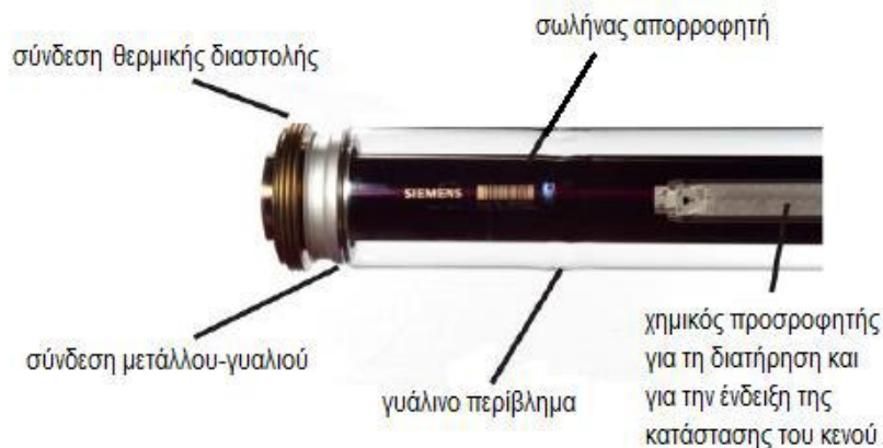
Εικόνα 3.2: Μέρη δέκτη [3]
