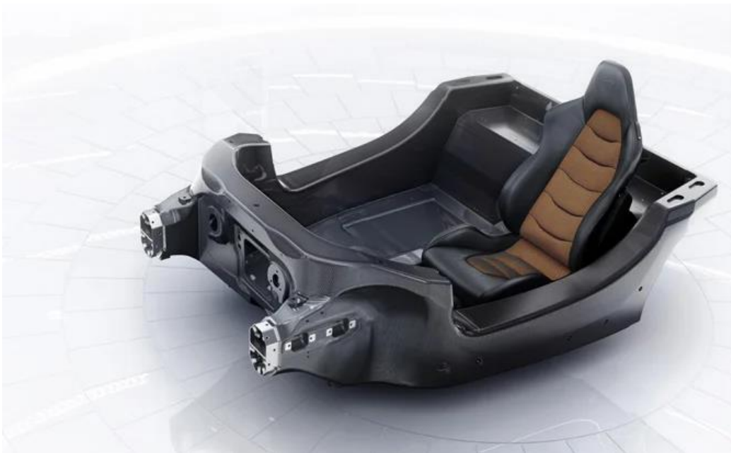
Σχήμα 6.1: Συνθετικό τμήμα πλαισίου αμαξώματος από ίνες άνθρακα, τύπου μοποσοque
