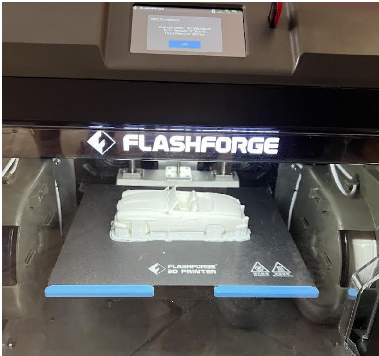
Σχήμα 3: Η τρισδιάστατη εκτύπωση του ολοκληρωμένου αυτοκινήτου, με τη χρήση του εκτυπωτή Flashforge Creator 3
