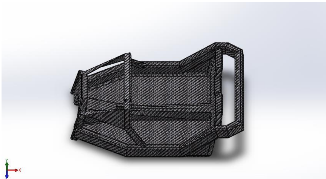
Σχήμα 6.5: Το νέο συνθετικό κεντρικό μέρος του πλαισίου του αυτοκινήτου, τύπου monocoque (δεύτερη όψη)
