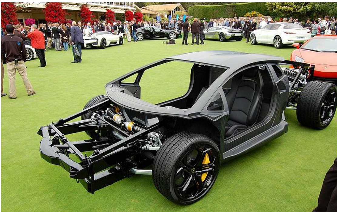
Σχήμα 6.3: Υβριδικό σασί αυτοκινήτου Lamborghini Aventador LP 700-4
