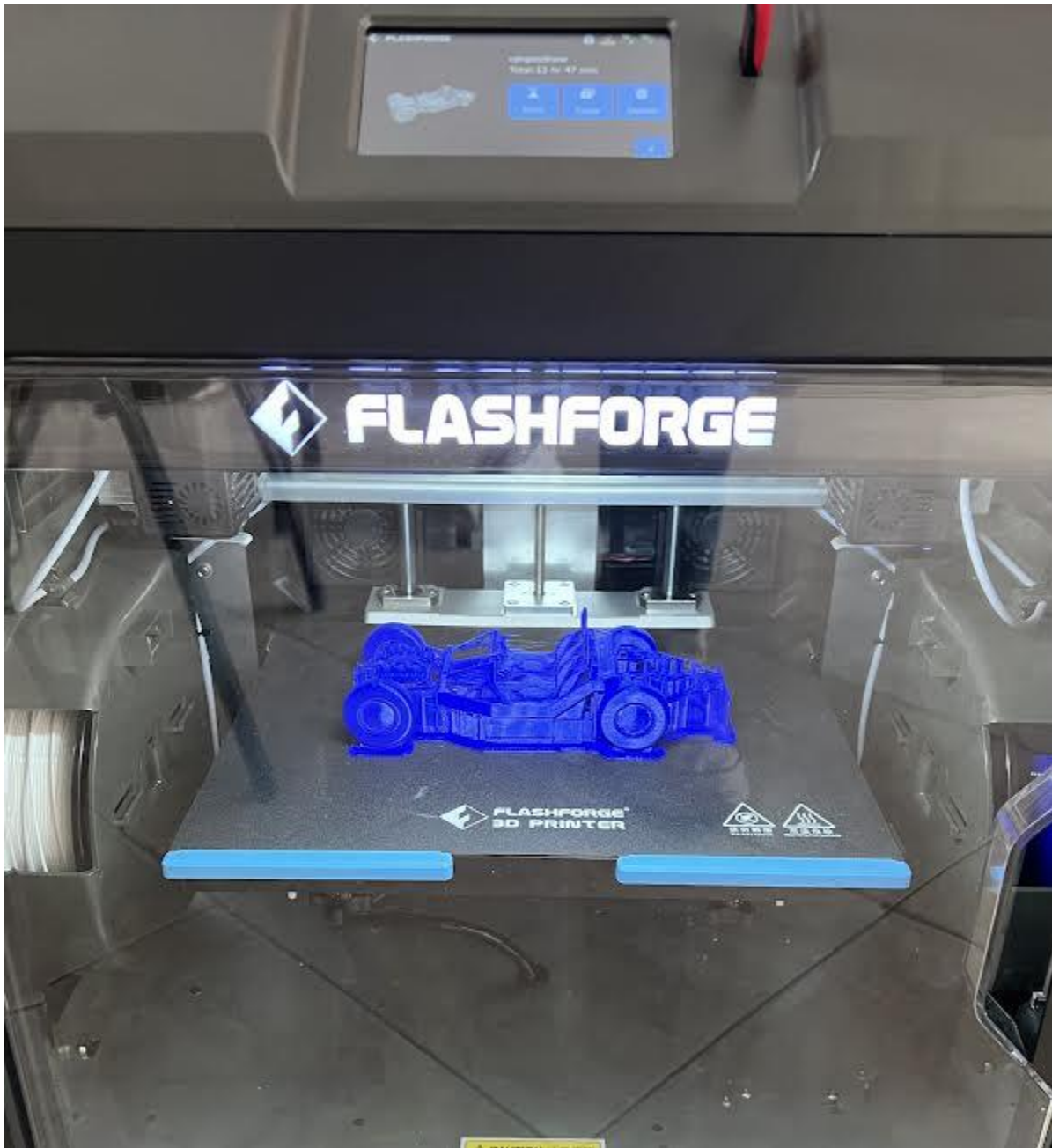
Σχήμα 2: Η τρισδιάστατη εκτύπωση του νέου πλαισίου, με τη χρήση του εκτυπωτή Flashforge Creator 3
