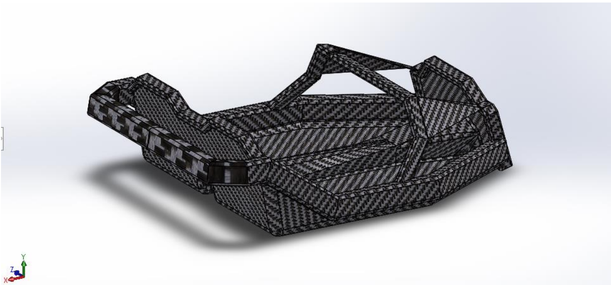
Σχήμα 6.4: Το νέο συνθετικό κεντρικό μέρος του πλαισίου του αυτοκινήτου, τύπου monocoque (πρώτη όψη)
