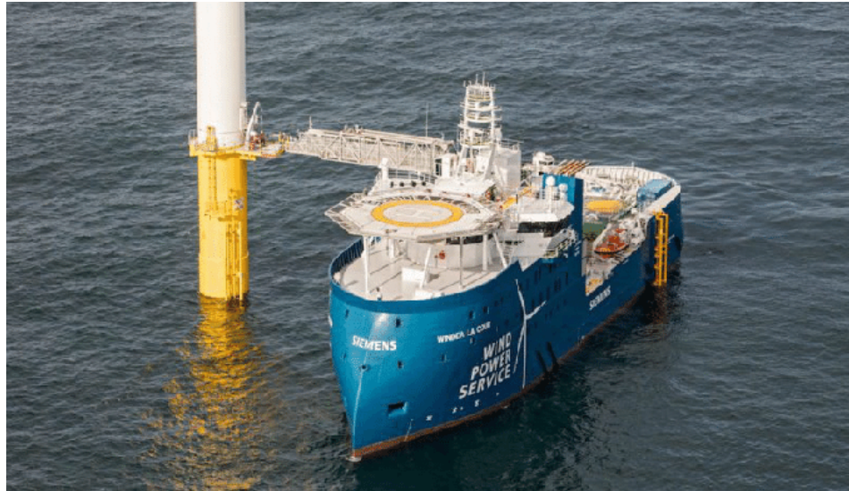
Σχήμα 2.8: Σκάφος συντήρησης (SOV), [2.7]
