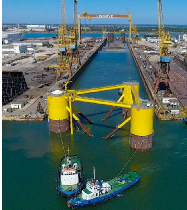
Σχήμα 2.12: Ρυμούλκηση ημιβυθιζόμενης πλατφόρμας (Semi-Submersible Platform) στο ναυπηγείο Λισνάβε της Πορτογαλίας, [2.20]
