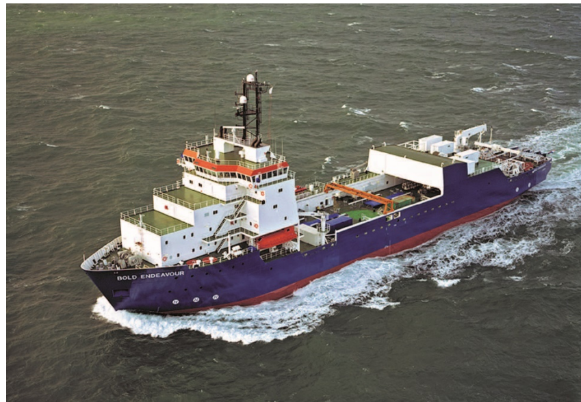
Σχήμα 2.5: Σκάφος τοποθέτησης καλωδίων, [2.4]
