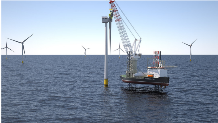
Σχήμα 2.6: Σκάφος εγκατάστασης ανεμογεννητριών (jack-up vessel), [2.5]
